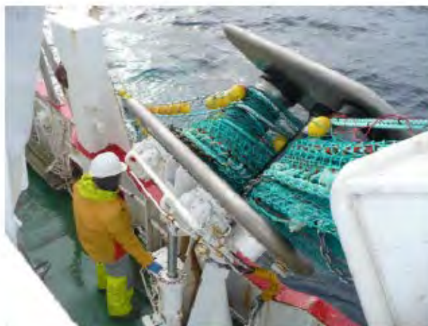
Bilde 6-10 Tørring av snurrevadssekk ved bruk av kraftblokk (notvinsj) (foto: SINTEF Fiskeri og havbruk)
